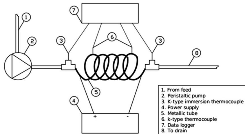
FIG. 1. SCHEMATIC REPRESENTATION OF THE TEST BENCH
