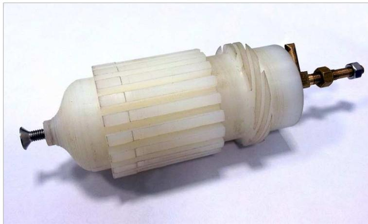
Figura 3: L'insieme raddrizzatore e deflettore utilizzato per le verifiche preliminari.
